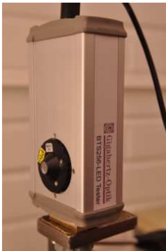
Kuva 6.3: BTS256-LED Tester varustettuna valovirran mittaamiseen tarkoitulla kartiolla.
