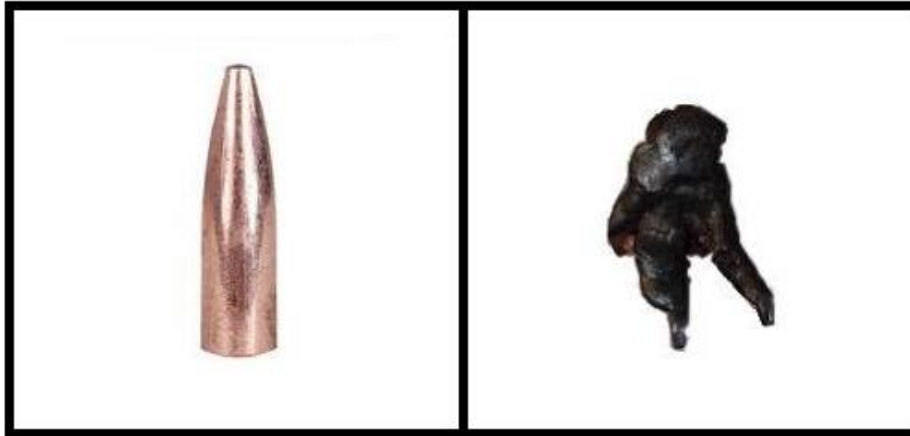
Kuva 1. Metsästysluoti ennen osumaa ja hirveen osumisen jälkeen. (vasen puoli Midway Suomi, oikea puoli Antti Ikäheimo)
